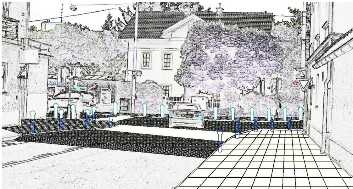
Das Abbiegen MG Richtung Westen in die Rochusgasse sollte unterbunden werden, um die in Nord-Süd Richtung versetzte Strassengeometrie zu korrigieren. Ein Abbiegeverbot von der Schwedenstrasse in Richtung Osten ist ebenfalls zu überdenken. Das bestehende Rechtsabbiegeverbot MG in Richtung Norden Schwedenstrasse wird baulich verdeutlicht.
